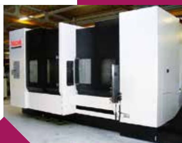
Retrofit cartérisation standard constructeur suivant besoin utilisateur
