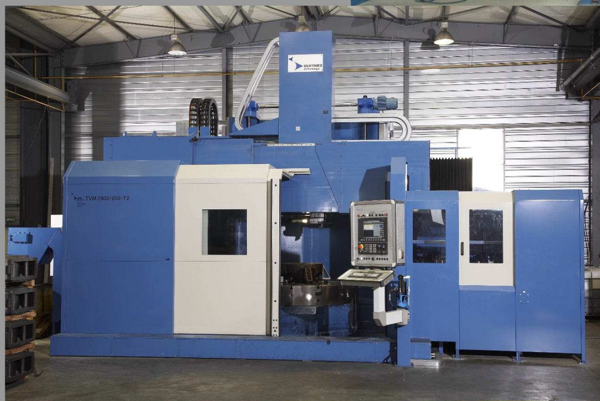
Tour haute pression Traverse mobile Chargement au pont Diam 280
