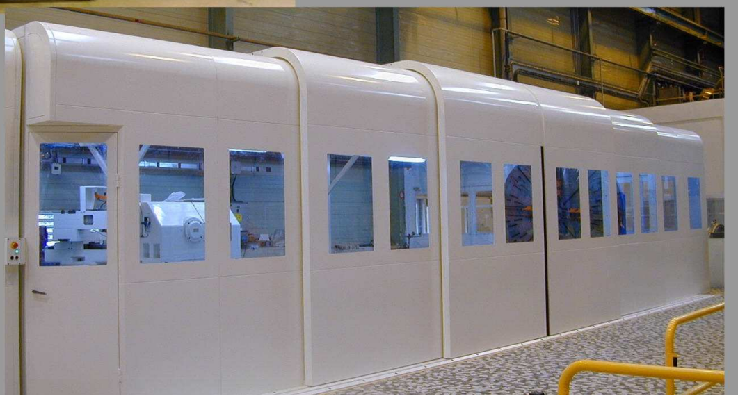
Tour de bobinage composite Chargement au pont pièce lg 8,5m ouverture en toiture profondeur 4,3m
