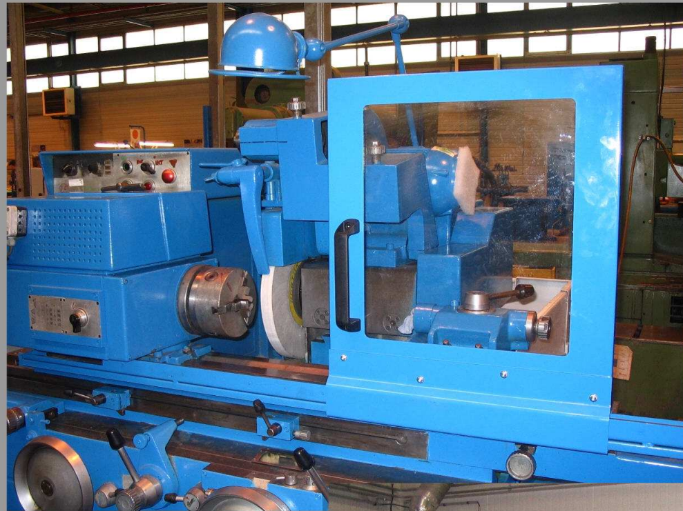
Ecran de protection pour rectifieuse conventionnelle
